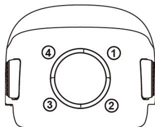
電源を切った状態で、電源ボタンを1秒間押し、すぐに離すと、電池残量が確認できます。LEDは、下図のように現在の電池残量を表示します。
