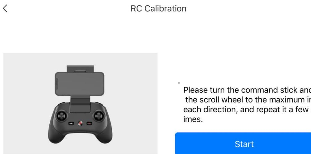
3. 左右のコマンドスティックとサムホイールを交互に、App の矢印の方向に最大まで動かします。方向のキャリブレーションが完了すると、その方向の矢印が青色になります。
