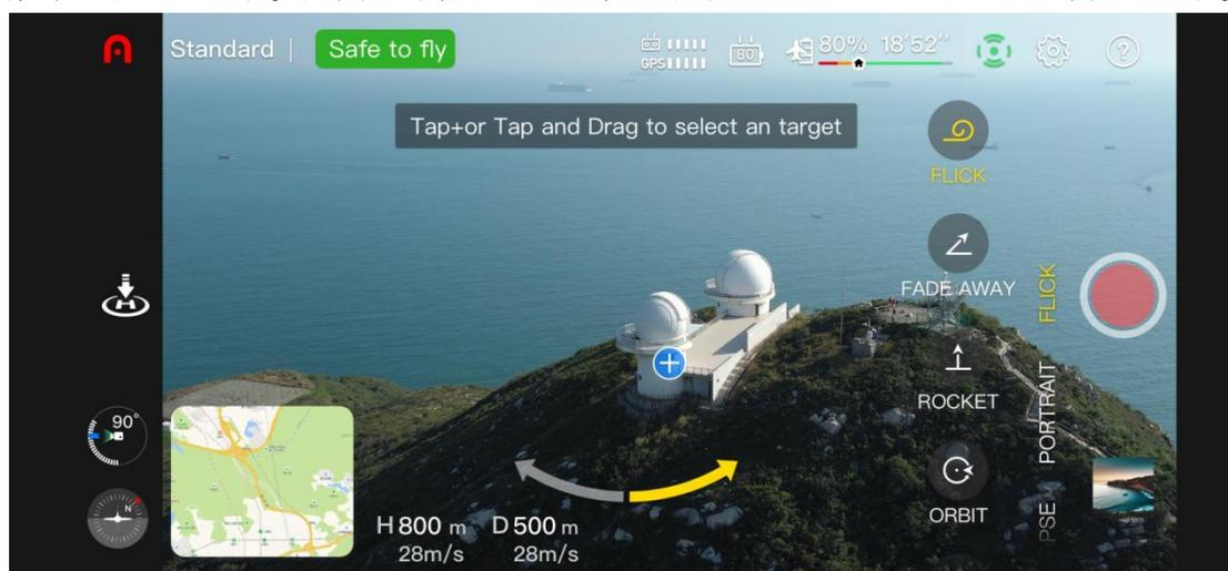
3. 任意のショートフィルムモードを選択後、画面上の被写体上で「+」をクリックするか、指で被写体を選択し、写真／ビデオボタンをクリックすると、機体が自動的に飛行してビデオを撮影し、撮影終了後にスタート地点に戻ります。
